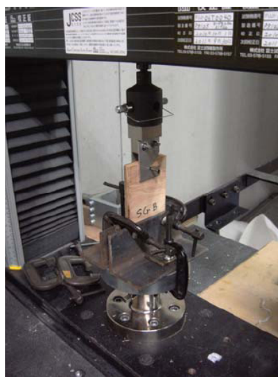
写真2: くぎ側面抵抗試験
