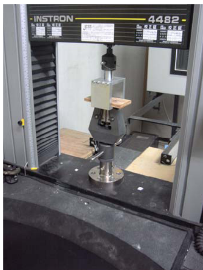
写真1: くぎ頭部貫通試験
