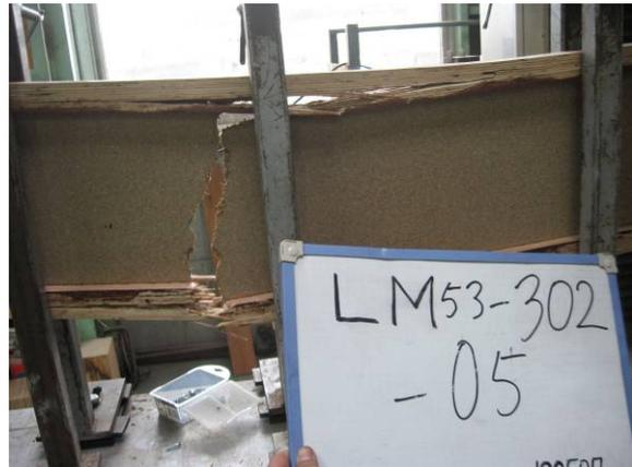
図3. 2. 4-2 Aタイプの破壊例
