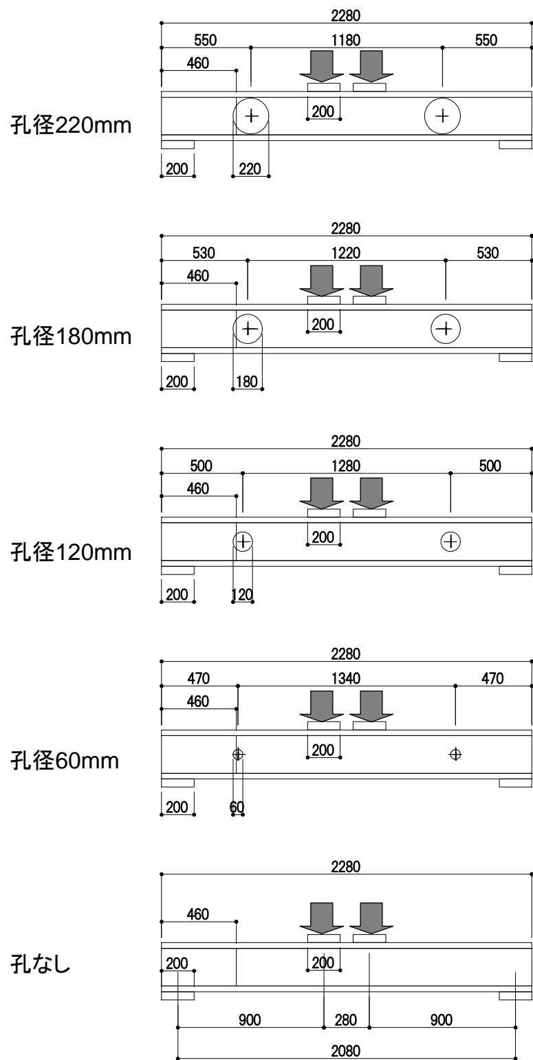
図6 単孔せん断試験方法
