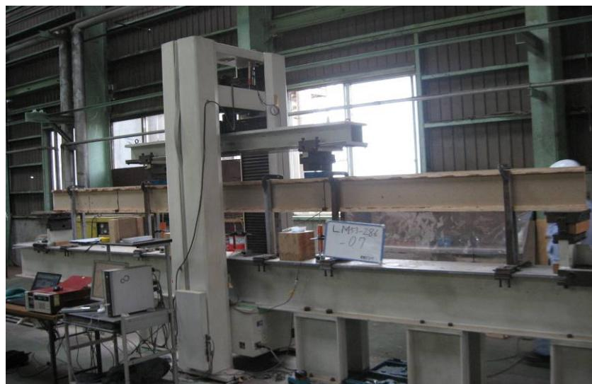
図3.2.4-1 曲げ試験方法
