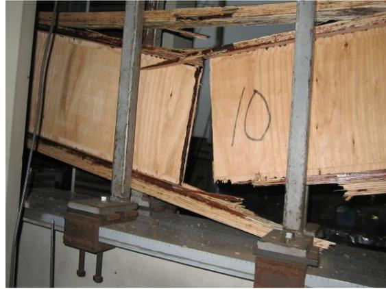
図3. 2. 4-3 Bタイプの破壊例
