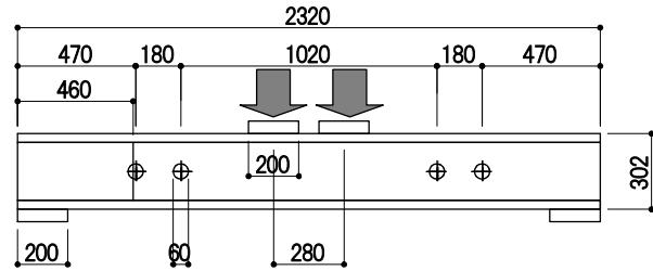
図7 複孔せん断試験方法
