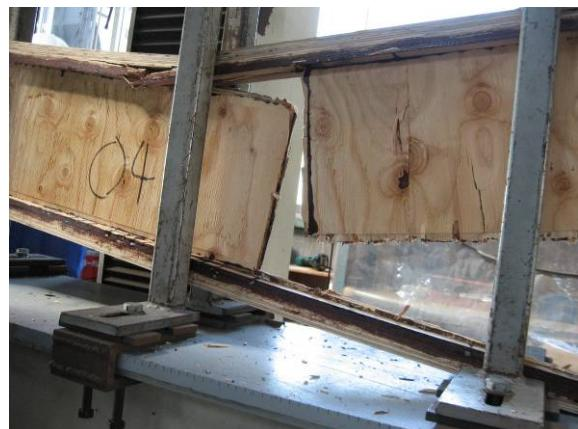
図3.2.4-4 C タイプの破壊例
