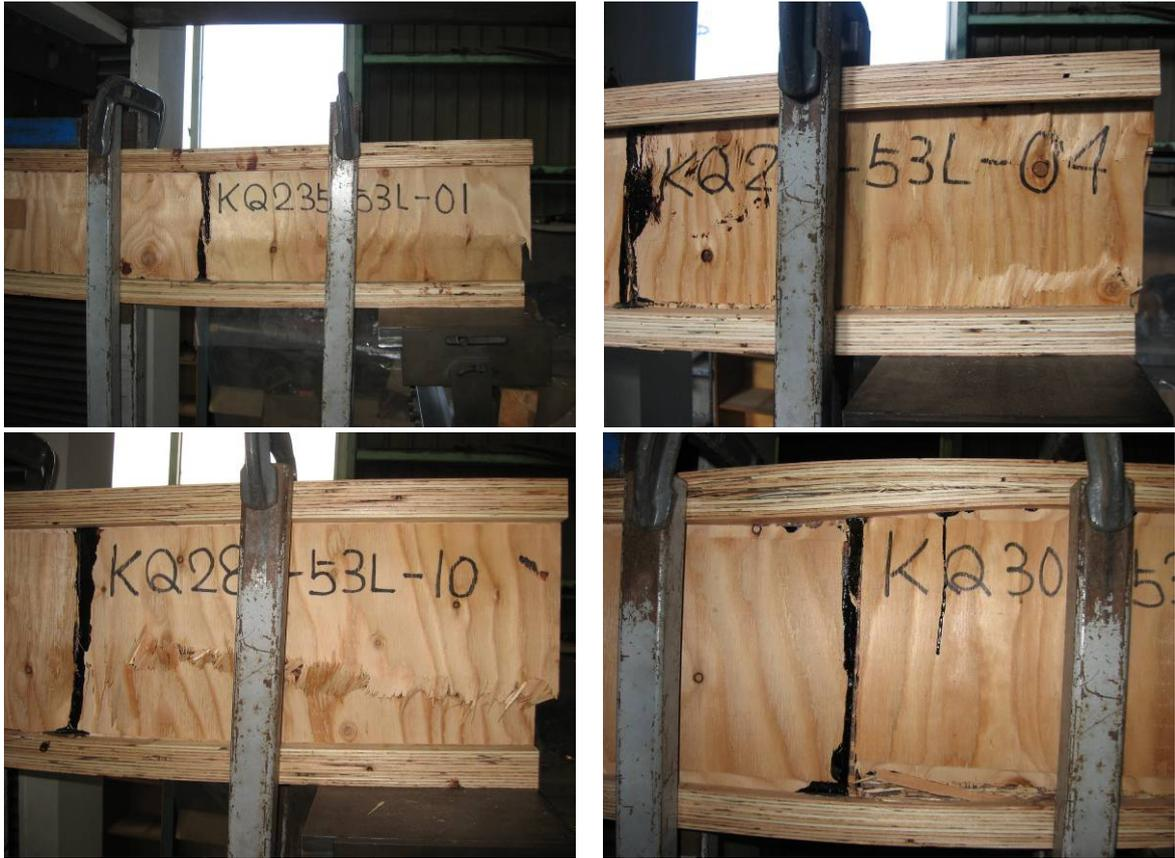
図3. 2. 5-3 Bタイプの破壊例
