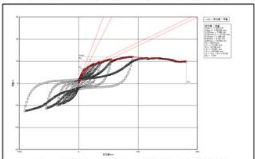
図5.2: K1+041-S433Y-SK15G-E93-N50@150-S-2の荷重-変位包絡線
