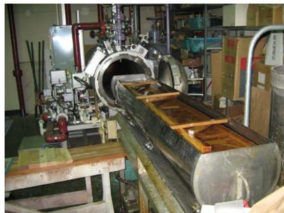
減圧加圧処理(加圧注入装置)
