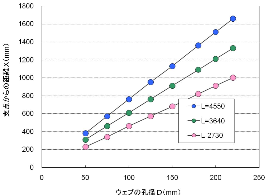
図11 ウエブの孔径に応じた孔あけ位置の試算結果(梁せい 302 の場合)
