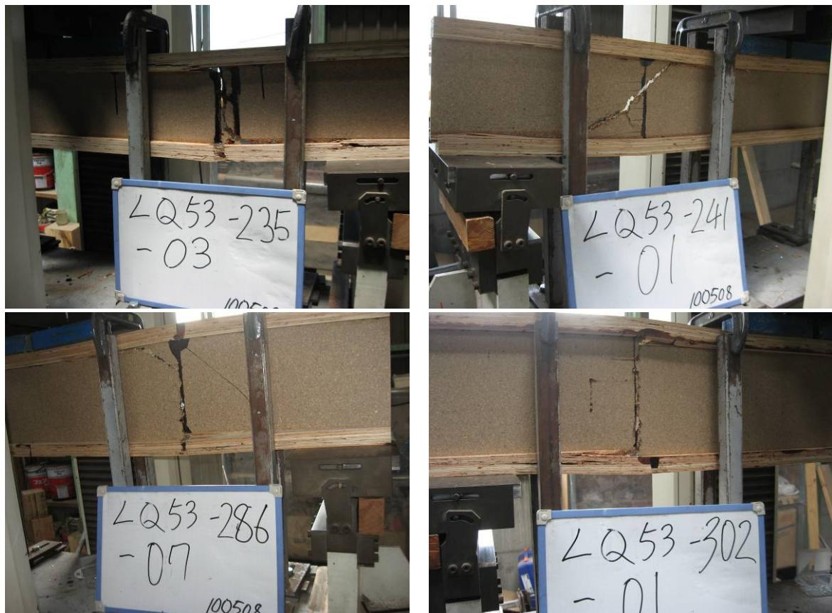
図3.2.5-2 A タイプの破壊例
