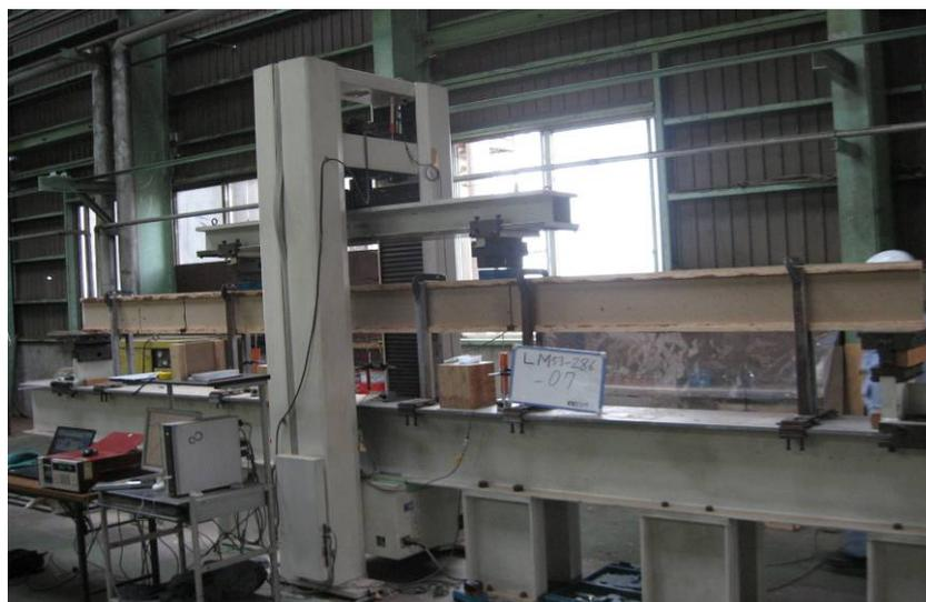
図3. 2. 4-1 曲げ試験方法
