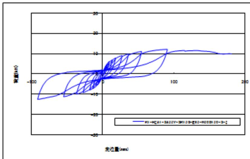
図4. 2:K1+041-S435Y-S15G-E95-N509150-S-2の荷重-変位曲線
