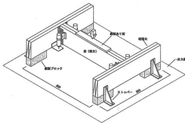
②端根太-梁（根太型）（根太受け金物、梁受け金物）
