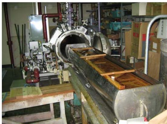
減圧加圧処理(加圧注入装置)
