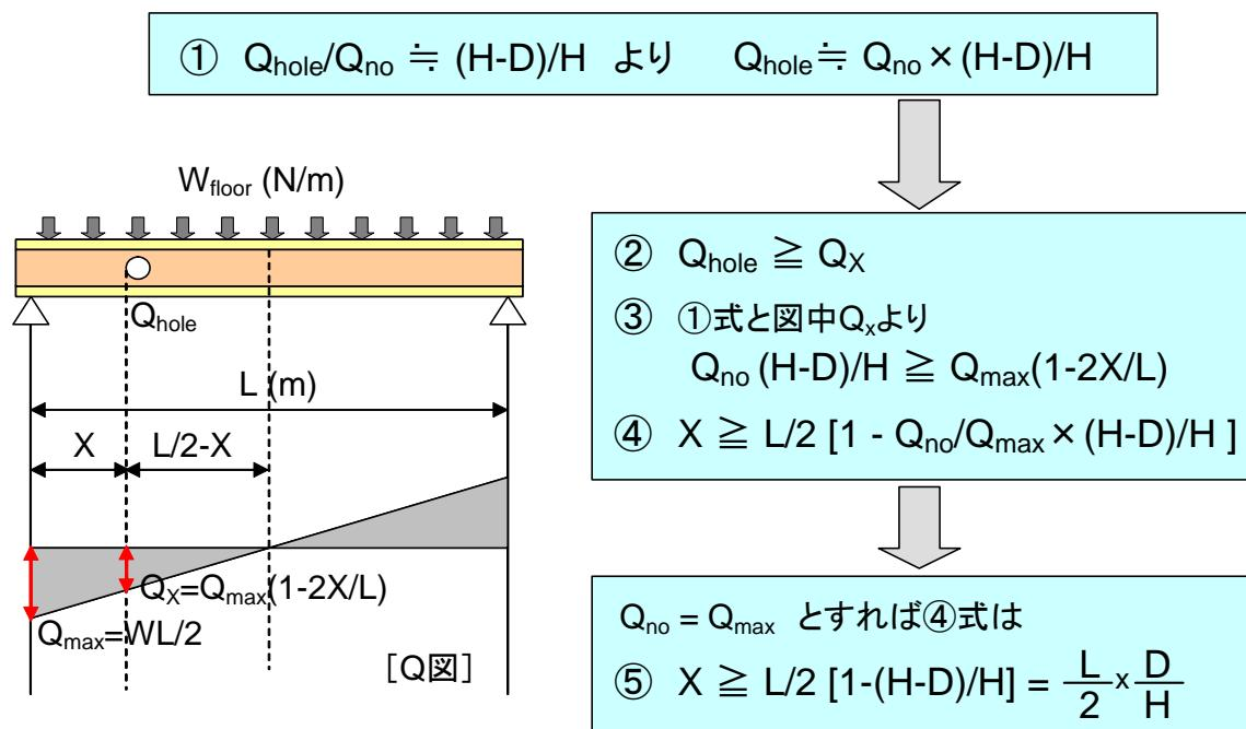
図10 せん断耐力と梁せいの残存率の関係式および孔あけ位置の設計手法
