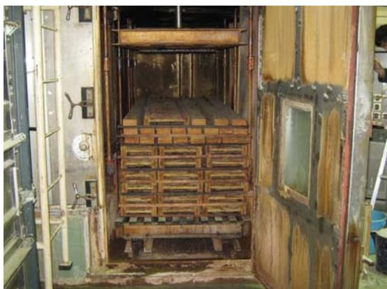
乾燥処理(蒸気式乾燥装置)
