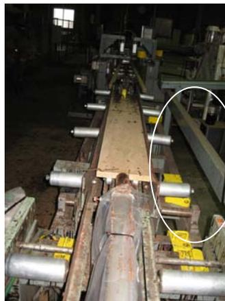
図 7.縦圧シリンダ 定板挿入後
