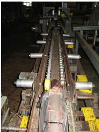
図 6.縦圧シリンダ 定板挿入前
