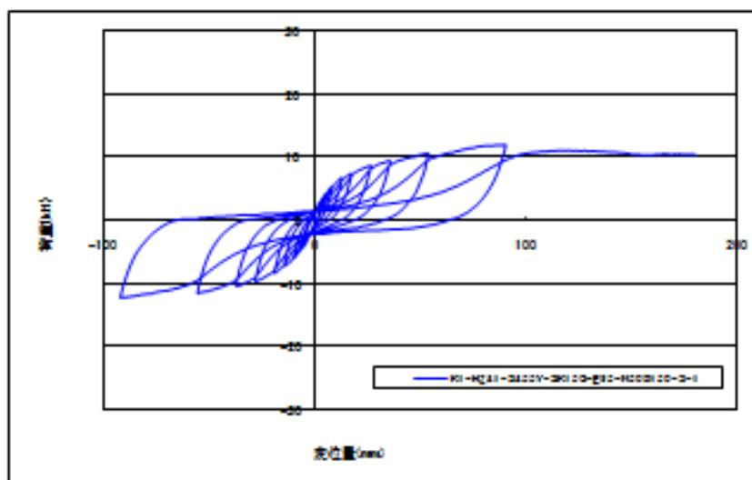
図4. 1:K1+041-S435Y-S15G-E95-N509150-S-1の荷重-変位曲線
