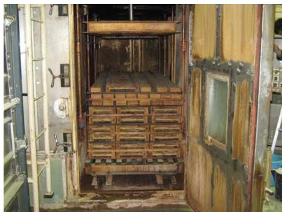
乾燥処理(蒸気式乾燥装置)
