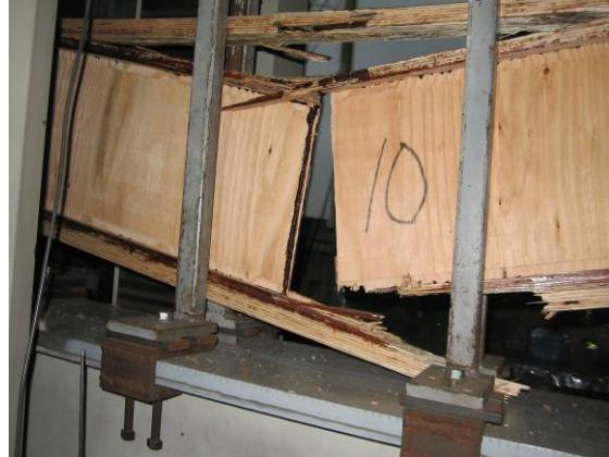
図3.2.4-3 B タイプの破壊例
