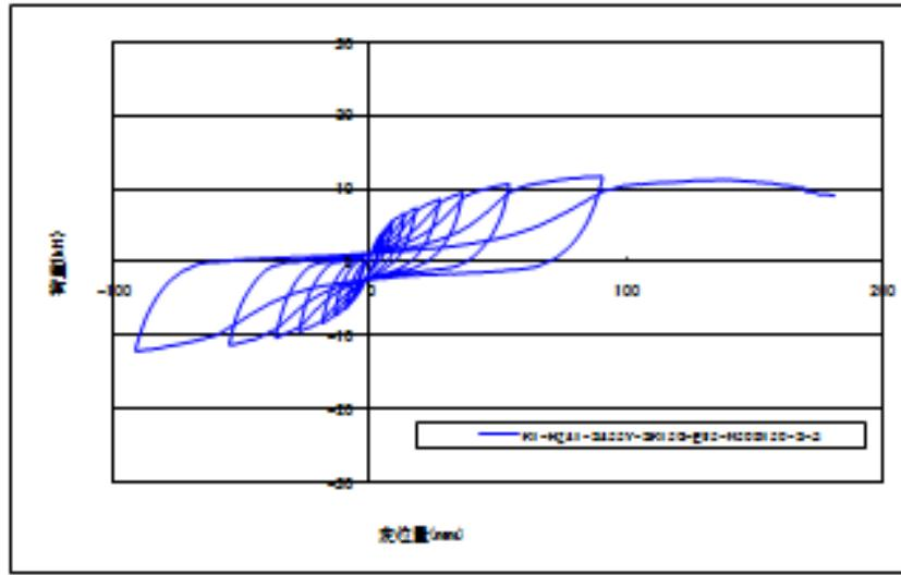
図4. 3:K1+041-S435Y-S15G-E95-N509150-S-3の荷重-変位曲線
