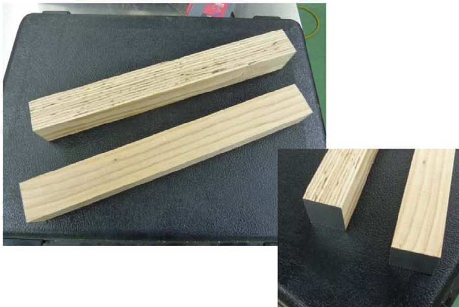
写真 試験片（木口面アルミテープでシール処理）
