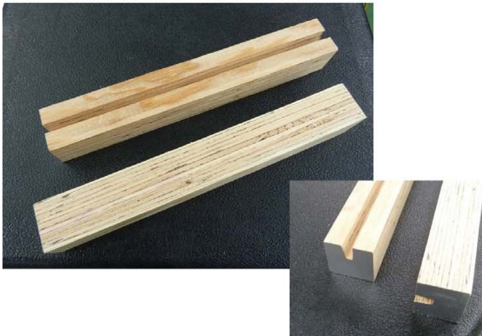
写真 試験片 (木口面アルミテープでシール処理)
