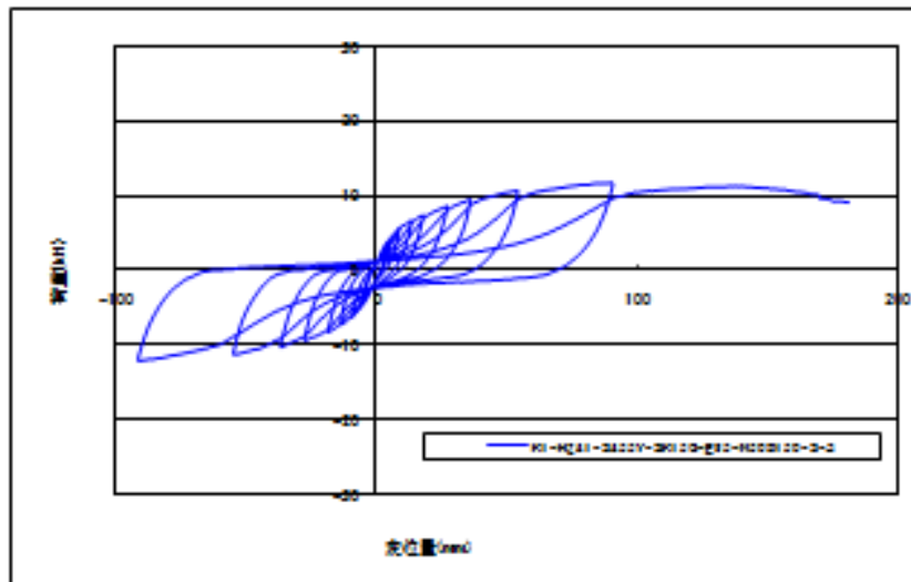
図4. 3: K1+Q41-S455Y-SK15G-E95-N50#150-S-3の荷重-変位曲線
