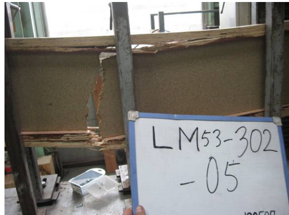
図3. 2. 4-2 Aタイプの破壊例
