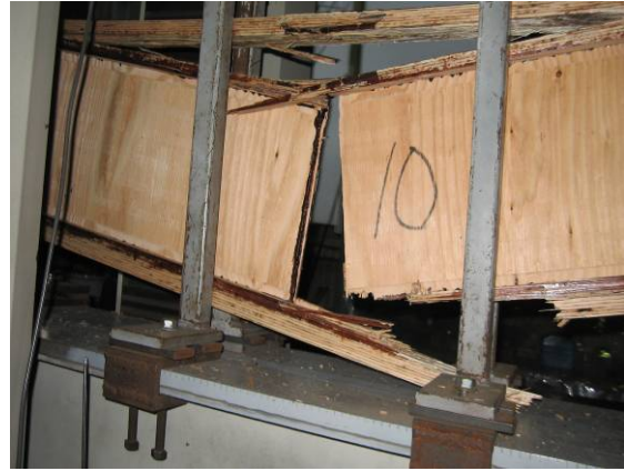
図3. 2. 4-3 Bタイプの破壊例
