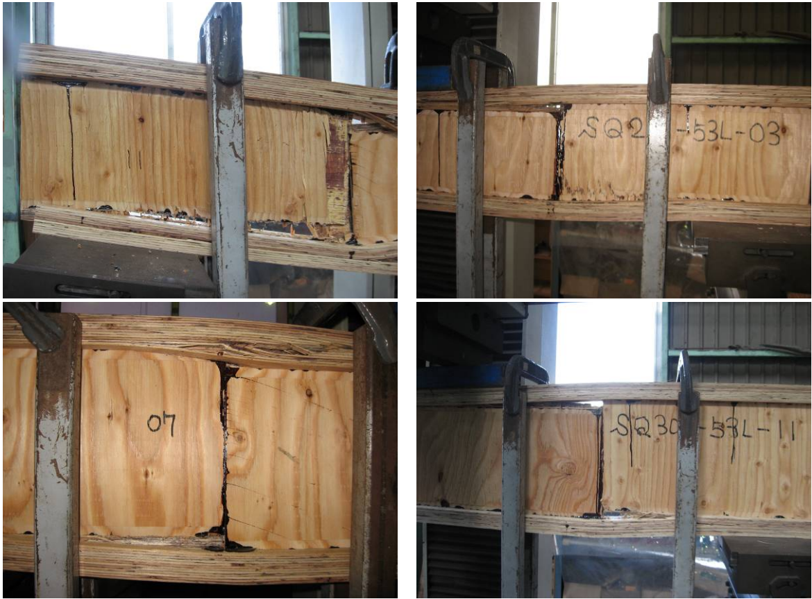
図3. 2. 5-4 Cタイプの破壊例
