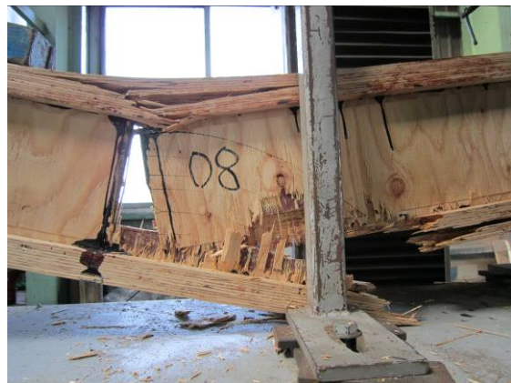
図3. 2. 4-2 Aタイプの破壊例
