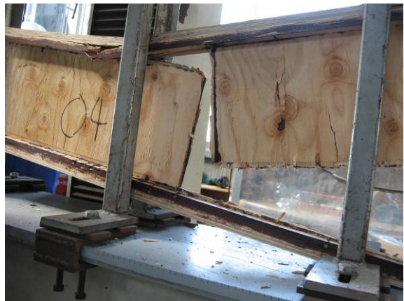
図3. 2. 4-4 Cタイプの破壊例
