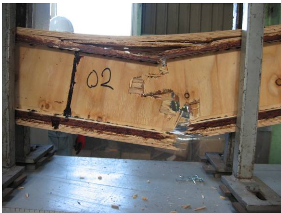
図3. 2. 4-2 Aタイプの破壊例
