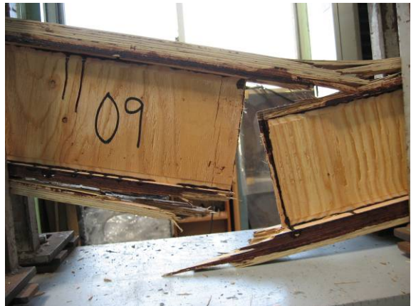
図3. 2. 4-3 Bタイプの破壊例
