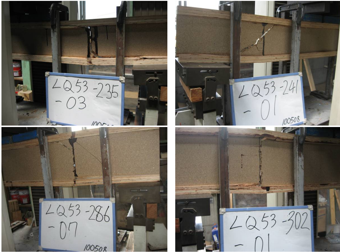
図3. 2. 5-2 Aタイプの破壊例
