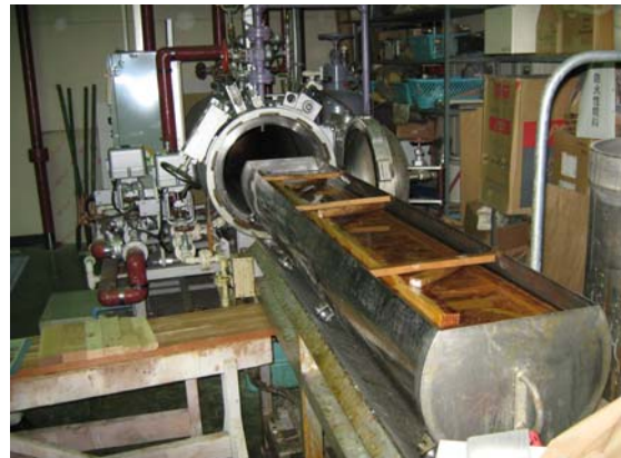
減圧加圧処理(加圧注入装置)
