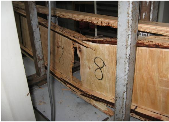
図3. 2. 4-3 Bタイプの破壊例
