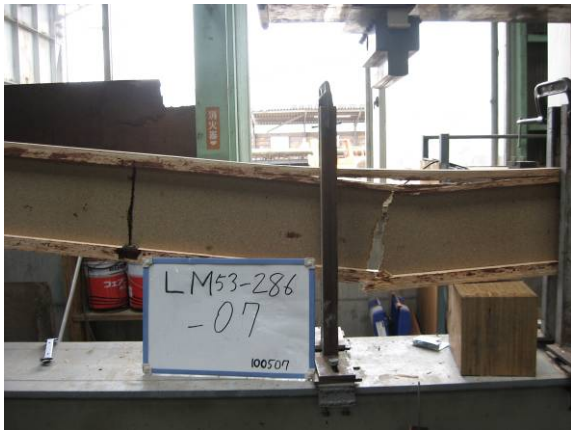
図3. 2. 4-2 Aタイプの破壊例
