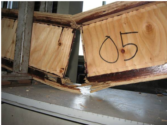
図3. 2. 4-3 Bタイプの破壊例
