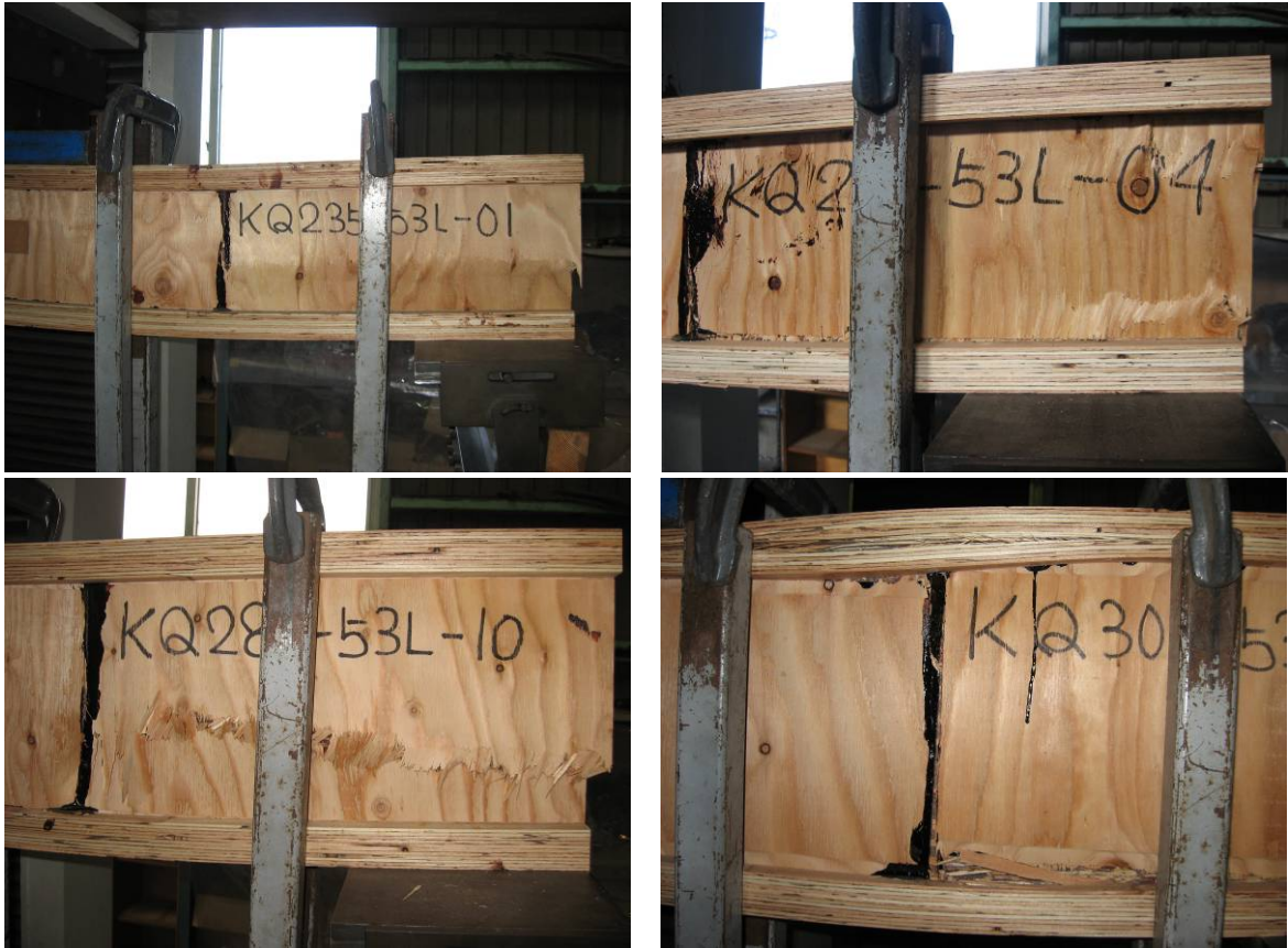
図3. 2. 5-3 Bタイプの破壊例
