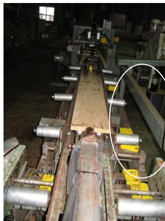
図 7.縦圧シリンダ 定板挿入後
