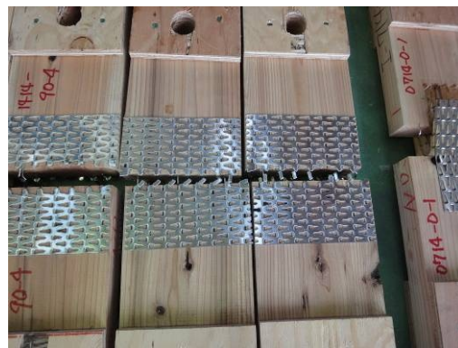
プレートの破断
