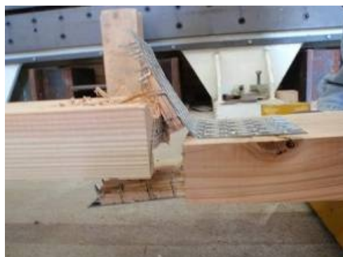
スギ材継手接合部
