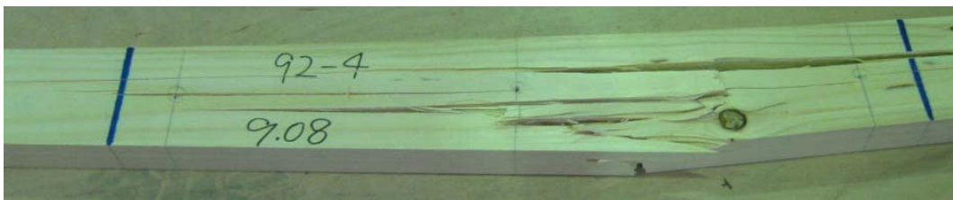
写真 3.3.4 曲げ破壊の代表例（小さな欠点）
