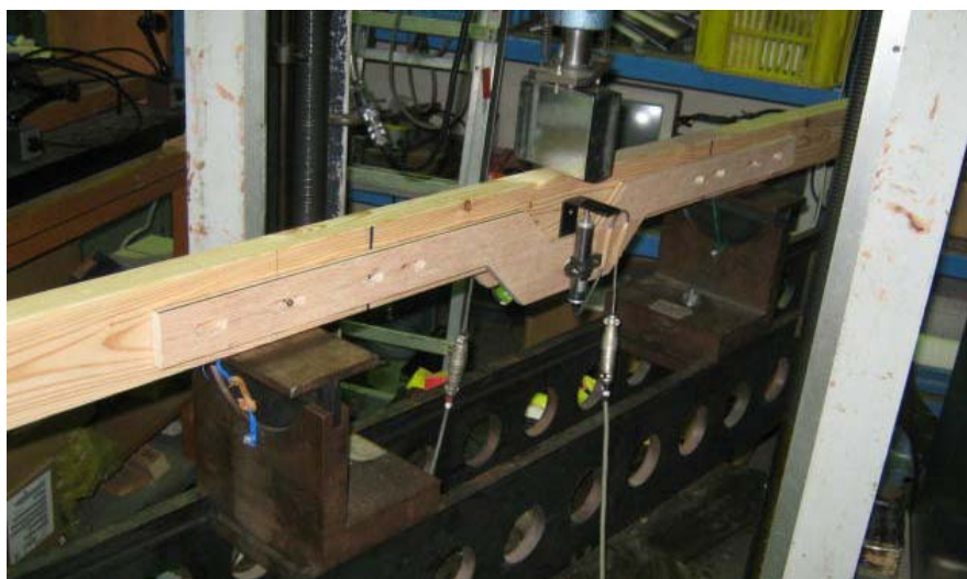
写真 3.3.18 せん断弾性係数測定方法
