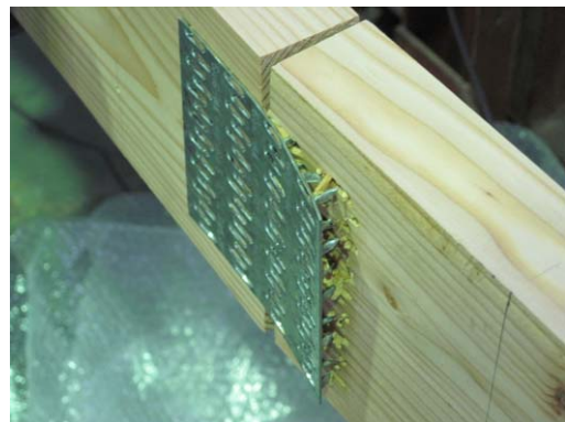
写真 3.4.8 破壊後の様子 (カラマツ)
