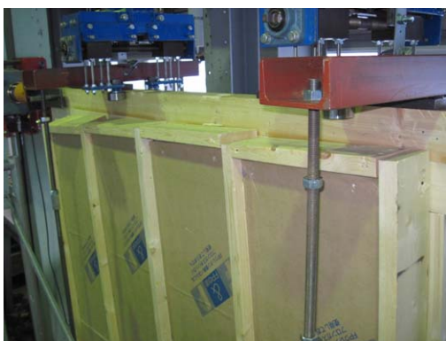
写真 7.1.7 破壊後の様子(千鳥継ぎ-3) パネル枠材の変形
