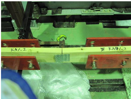
写真 3.4.7 破壊後の様子 (カラマツ)
