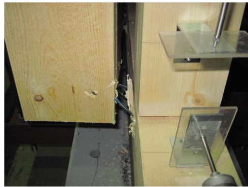
写真 7.1.12 壊後の様子(一丁継ぎ-2) パネルの離脱
