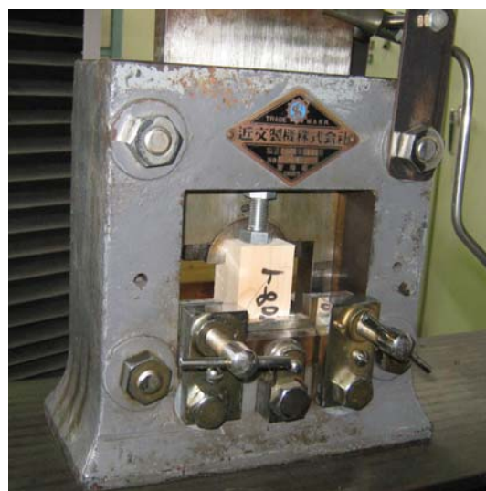
写真 3.3.16 ブロックせん断試験方法
