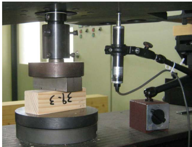
写真 3.3.15 めり込み試験方法
