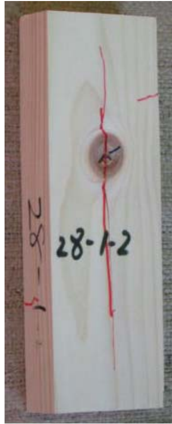
写真 3.3.11 圧縮破壊の代表例（材縁部の節）
