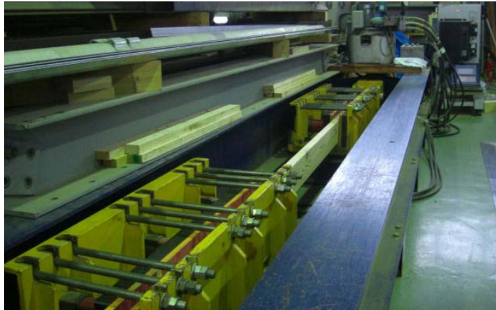
写真 3.3.5 引張試験方法
