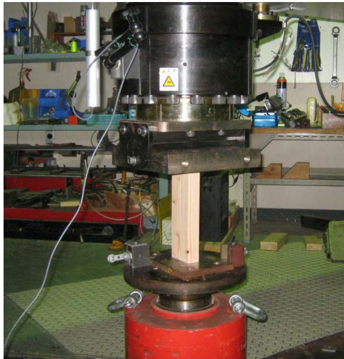
写真 3.3.10 縦圧縮試験方法
