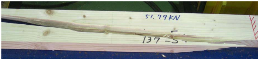
写真 3.3.7 引張破壊の代表例 (材中央の節)
