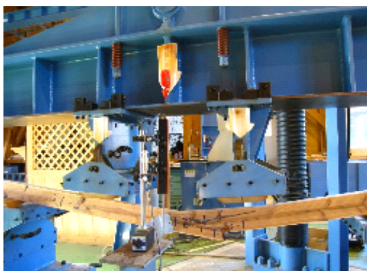
写真3 曲げ試験の様子
