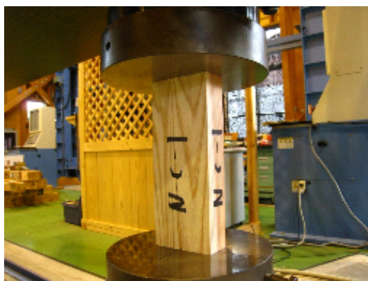
写真5 縦圧縮試験の様子
