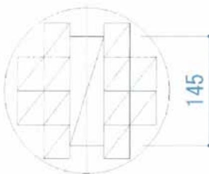
木取り図 末口直径 220mm
