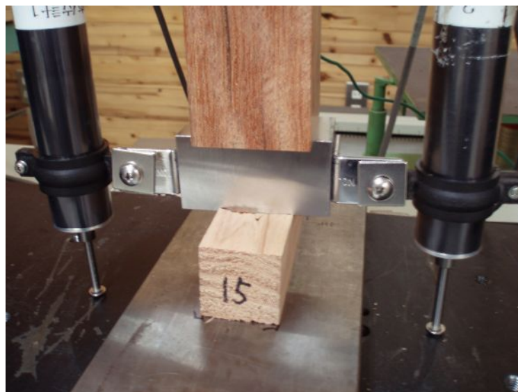
むり込み試験状況
