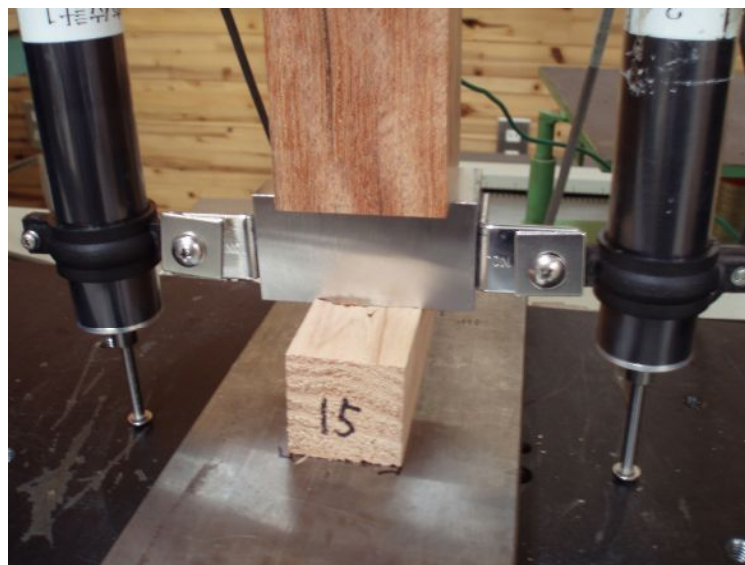
むり込み試験状況
